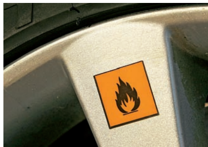
Premium Seal: Ein Aufkleber weist auf entzündliches Gas im geflickten Reifen hin
