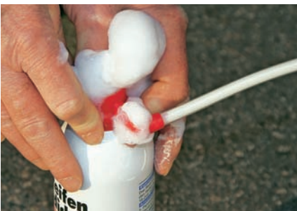
Nigrin: An der Flasche tritt Dichtmittel aus, es kommt zu unerwünschtem Hautkontakt
