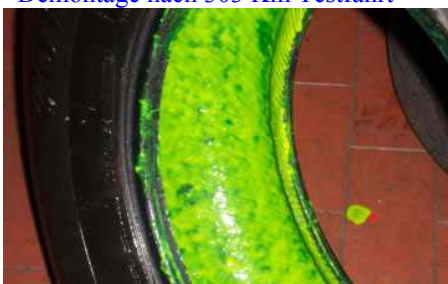
Innenseite ganzflächig abgedichtet
