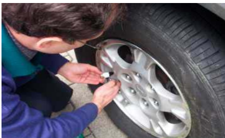
Ventil wird versiegelt
