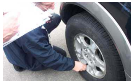
Druckkontrolle auf Testfahrt
