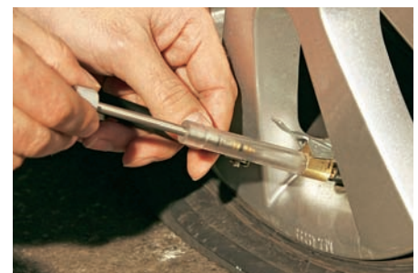
Premium Seal: Durch das geschlossene System kann das Ventil nicht verloren gehen
