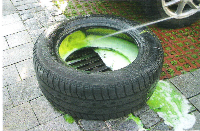
Premium-Seal Repair ist wasserlöslich und kann einfach entsorgt werden. Reste des Mittels können sogar durch die Kanalisation weggespült werden.
