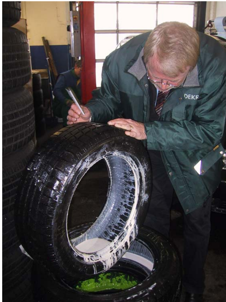
Foto: Nach der Demontage war Reifen, Felge und Arbeitsgerät durch das verwendete Latex-Produkt (weiß) stark verunreinigt. Der unten liegende, mit PREMIUM-SEAL Repair (grün) befüllte Reifen, verursachte bei der Demontage keine Verunreinigung.
