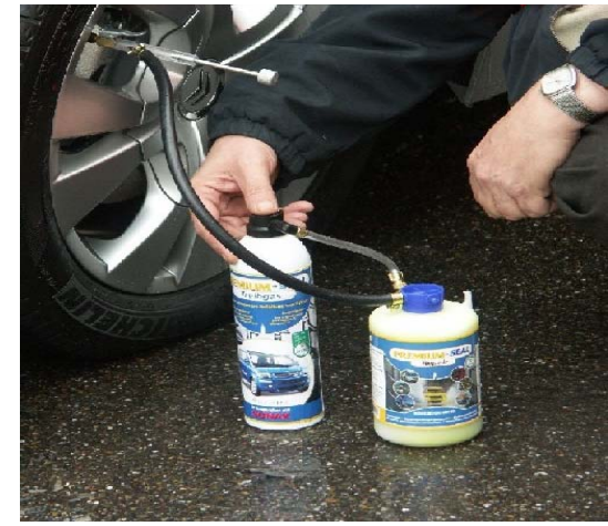
Einfüllvorgang mit Treibgas und Komfortflasche
