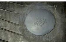
eines DEKRA-Tests: Mit PREMIUM-SEAL AIO Comfort Plus behandelte Reifen können technisch gesehen, repariert werden. Der Testreifen wurde im Auftrag der DEKRA bei der Firma Stahlgruber mit Minikombi A6 fachgerecht repariert und hat den anschließenden Test nach ECE R30 sogar unter höheren Bedingungen als vorgeschrieben bestanden.
