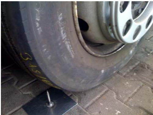
Bild 2) Nageltest mit 10 mm Fremdkörper
