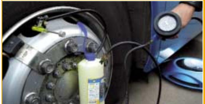
**AUFGEPUMPT** Mit Hilfe des Reifenfüllanschlusses am Bus wird das Dichtmittel über das Ventil in den Reifen gepumpt
