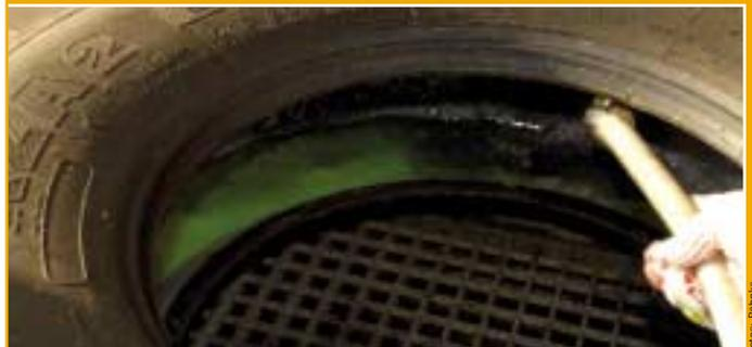
**REINIGUNG** Soll das Rad später repariert werden, kann das Dichtmittel einfach mit Wasser aus dem Reifen gespült werden
