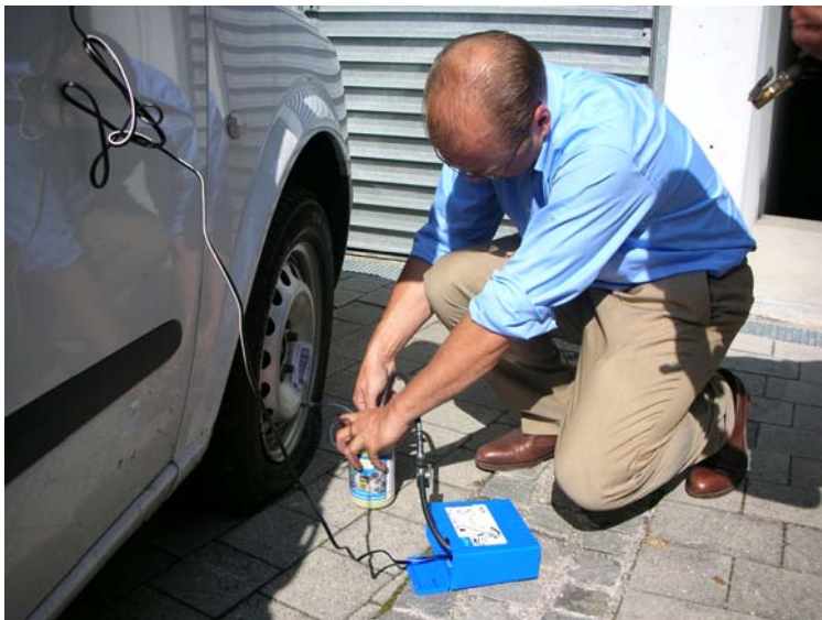
Versuchsfahrzeug A: Einsatz von PREMIUM-SEAL Repair Dauer 3 Min. 30 Sek.
