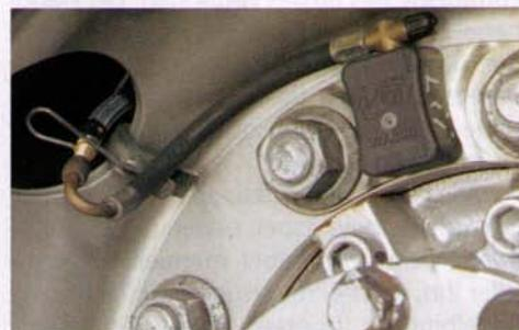
Jedes einzelne Rad verfügt für die präzise Anzeige über einen Drucksensor.
