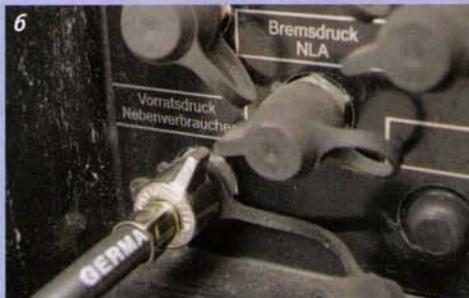
6 Druckschlauch des Pannensets an der Druckluft-Bordanlage anschließen.
