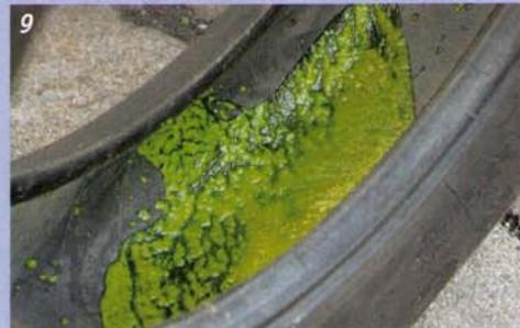
9 Die Dichtflüssigkeit wird nach der späteren Reifendemontage ausgewaschen.
