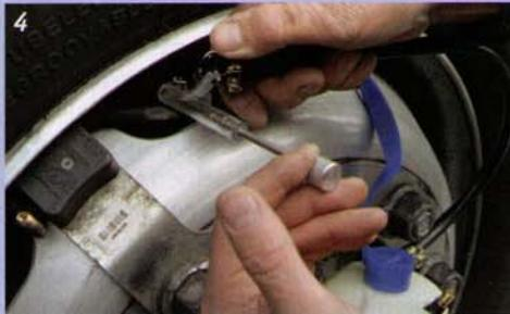
4 Mit dem Ventilheber das Ventil entfernen, ohne Ventil geht es später nicht weiter.
