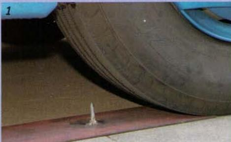
1 Beim ersten Test rollt der Reifen über einen Stahldorn mit acht Millimetern.
