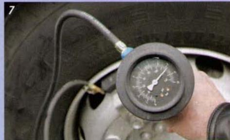
7 Kontrolliert den Reifen erst mit dem Dichtmittel und weiter mit Luft befüllen.
