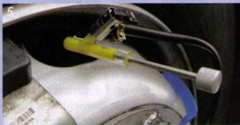
5 Die Flasche mit dem Reifendichtmittel wird ans Rad gehängt und angeschlossen.
