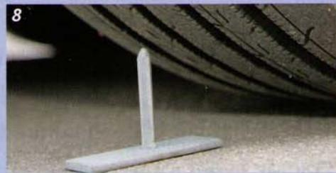
8 Im zweiten Test dichtet das Set auch das Loch eines Zwölf-Millimeter-Dorns ab.
