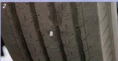
2 Zuerst Fremdkörper vorsichtig mit einer Zange aus dem Reifen entfernen.
